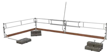
ABS Mobile Guard Pro (Flachdach) Fussleiste / ABS Mobile Guard Pro (Flat Roof) Toe Board Bordbrett aus Holz, mit stirnseitigem Beschlag zur Einhängung. Höhe: 0,15 m; Länge: 3,07 m; Gewicht: 6,5 kg.
